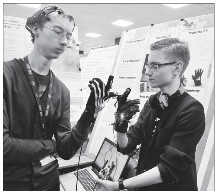
Даниил Веловатый и Максим Хивинцев делают программу, которая позволит управлять протезом руки с помощью нейроинтерфейса
