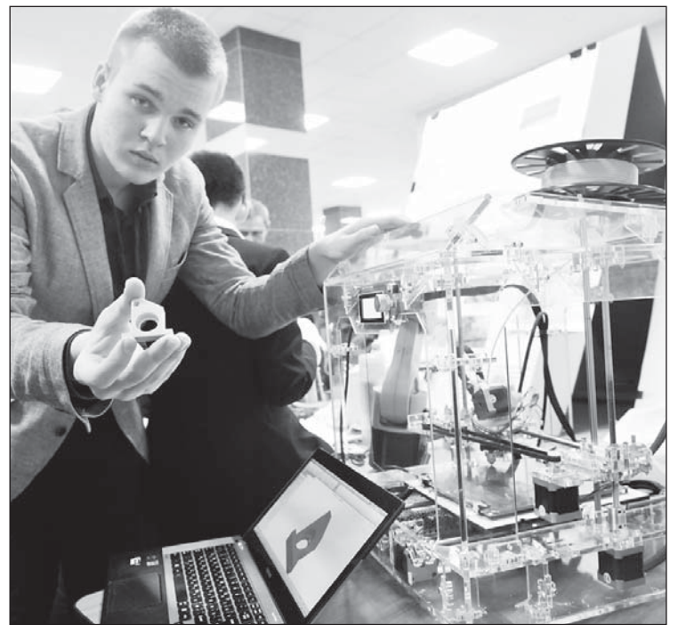
Это пластмассовая деталь для робота, которую Олег Зобов изготовил на собственноручно сделанном 3D-принтере
